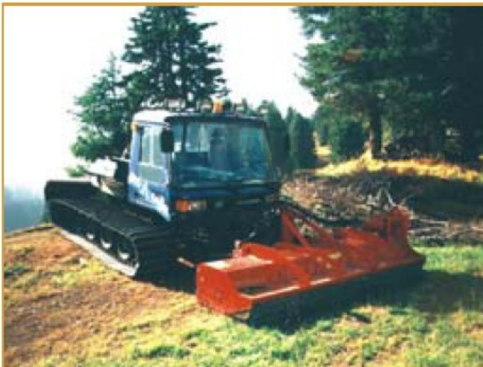
Optional: OLS-s cu actionare hidraulica montat la un utilaj de curatat partiile de schi
