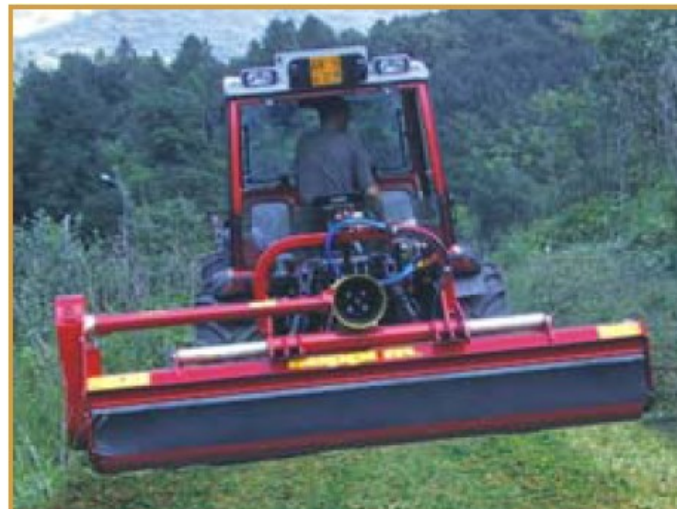
Placa posteriora de inchidere reglabila, prevazuta cu perdea de cauciuc
