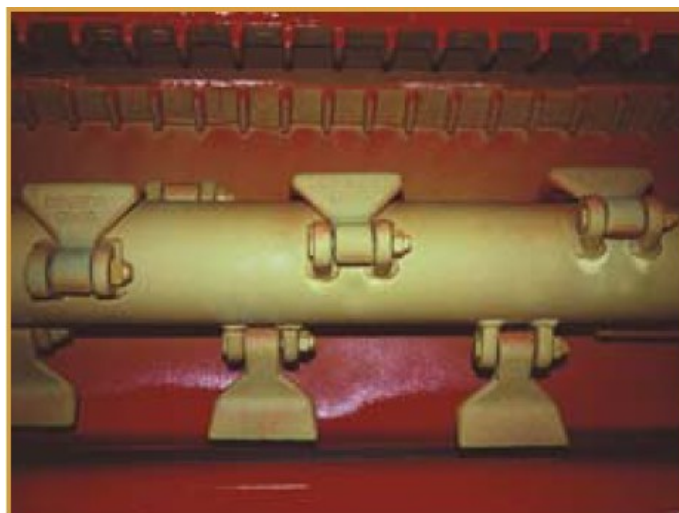
Rotor OLS cu ciocane montate in spirala si contracutite din fier forjat
